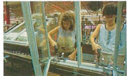
ケースメント窓の組立。
